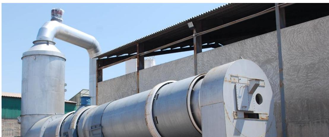
**Figura 7.** Hornos de incineración. Obtenido de talleres Guillén.
